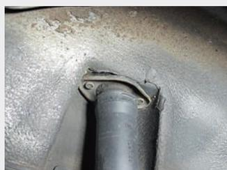
Poltert die Hinterachse, liegt es an den oberen Dämpferaufnahmen...
