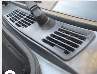
**7** ...gammelt. Lochfraß am Scheibenrahmen kommt stets von innen (Lüftungsgitter raus), der...
