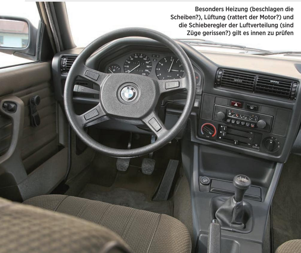
Besonders Heizung (beschlagen die Scheiben?), Lüftung (rattert der Motor?) und die Schieberegler der Luftverteilung (sind Züge gerissen?) gilt es innen zu prüfen
