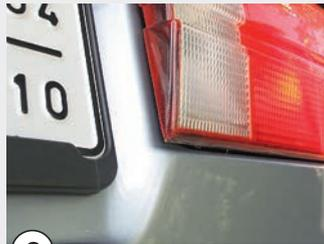
**6** Das Blech um die Rückleuchten ist rostgefährdet, speziell beim Kombi, dessen Heckklappe...
