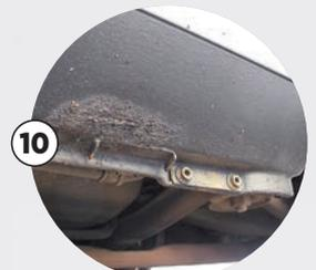
Hier wurde auch schon geflickt: Die Wagenheberaufnahmen sind oft angenagt, aber recht einfach instandsetzbar, da nur aufgesetzt
