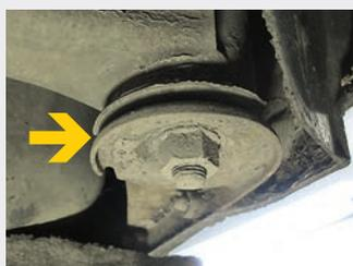
...oder maladen Tonnenlagern, bei denen kein Spalt mehr zu sehen ist
