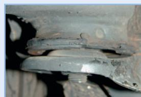
Lager der Hinterachse: Ist der Spalt zu, ist das Lager hinüber
