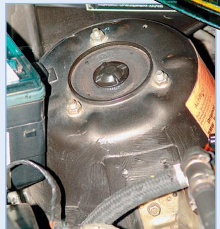
Klassiker: An den vorderen und hinteren Stoßdämpferdomen nagt die Korrosion
