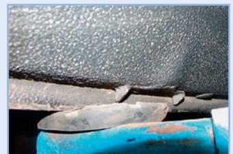
**Schweller:** Die Ausbuchtungen (Wagenheberaufnahmen) verrotten
