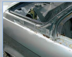
C-Säule: Auch hier gammelt im Schutz des Verdeckes die Lötnaht zwischen Baur- und BMW-Blech
