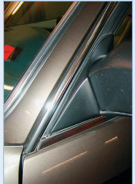
Leise rieselt Oxid: Die Spiegel-Dreiecke aus Aluminium korrodieren mit den Jahren
