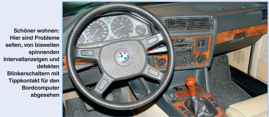
**Schöner wohnen:** Hier sind Probleme selten, von bisweilen spinnenden Intervallanzeigen und defekten Blinkerschaltern mit Tippkontakt für den Bordcomputer abgesehen
