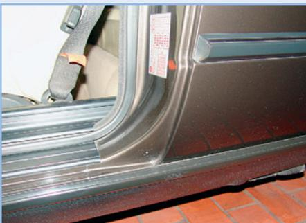
**Lochfraßgefahr:** Besonders im Bereich zwischen Schweller, B-Säule und Seitenteil sollte genau...
