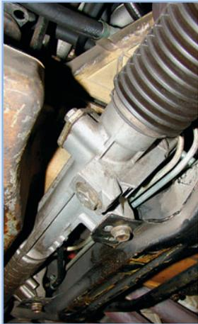
**Lenkgetriebe:** Ist es undicht, steht der Austausch an
