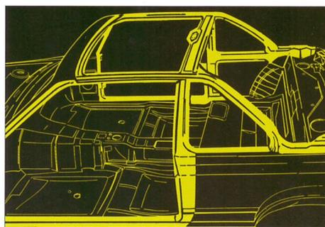
aktive und passive Sicherheit. Hohe Verwindungssteifigkeit des Karosserieaufbaus. Mit den fahrdynamischen Eigenschaften einer Limousine. Und den entsprechenden Dachlasten.
