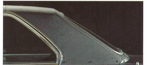
hochwertigem Keflar-Werkstoff. So wird aus dem einmalig flexiblen Cabrio ein Coupé mit „fester“ Heckscheibe und Scheibenheizung. Perfekt gestylt, langgestreckt und ästhetisch in der Linienführung.
